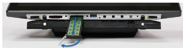
Jednoduchý způsob výměny M.2 SSD disku
